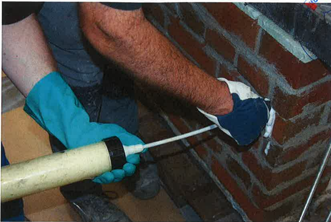
Bild B3: Injizieren mittels handbetriebener Kartuschenpumpe in die Prüfkörper
